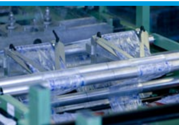
Weitertransport der fertig verschweißten Folie.
