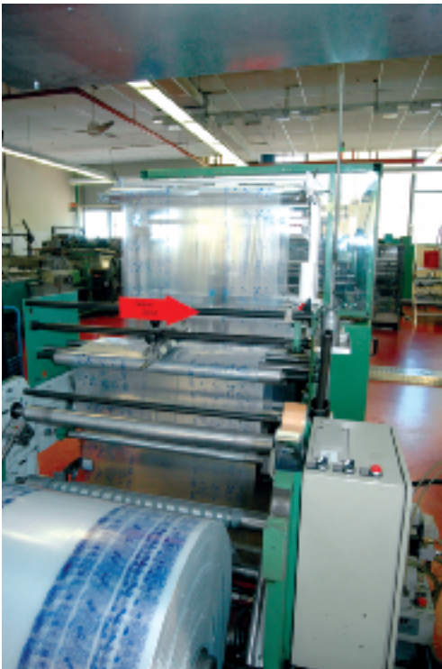
Die über Exzenter angetriebene Schweißstation und Perforation arbeiten synchron zueinander.
